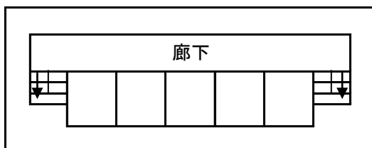
《両側に直通階段が設けられた例》
