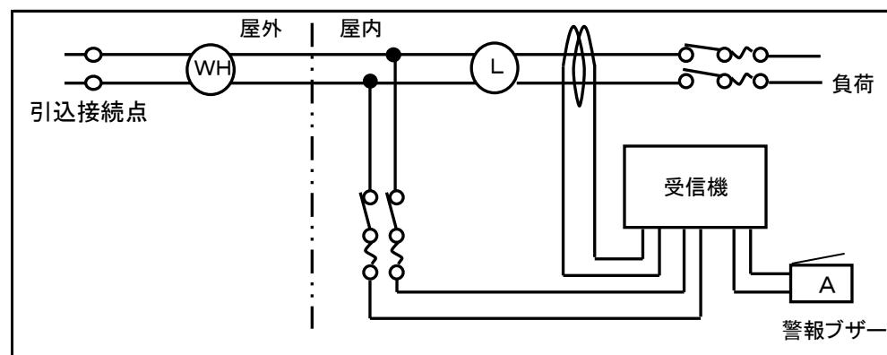
(3) 変圧器のB種接地線に設ける方式の設置例
