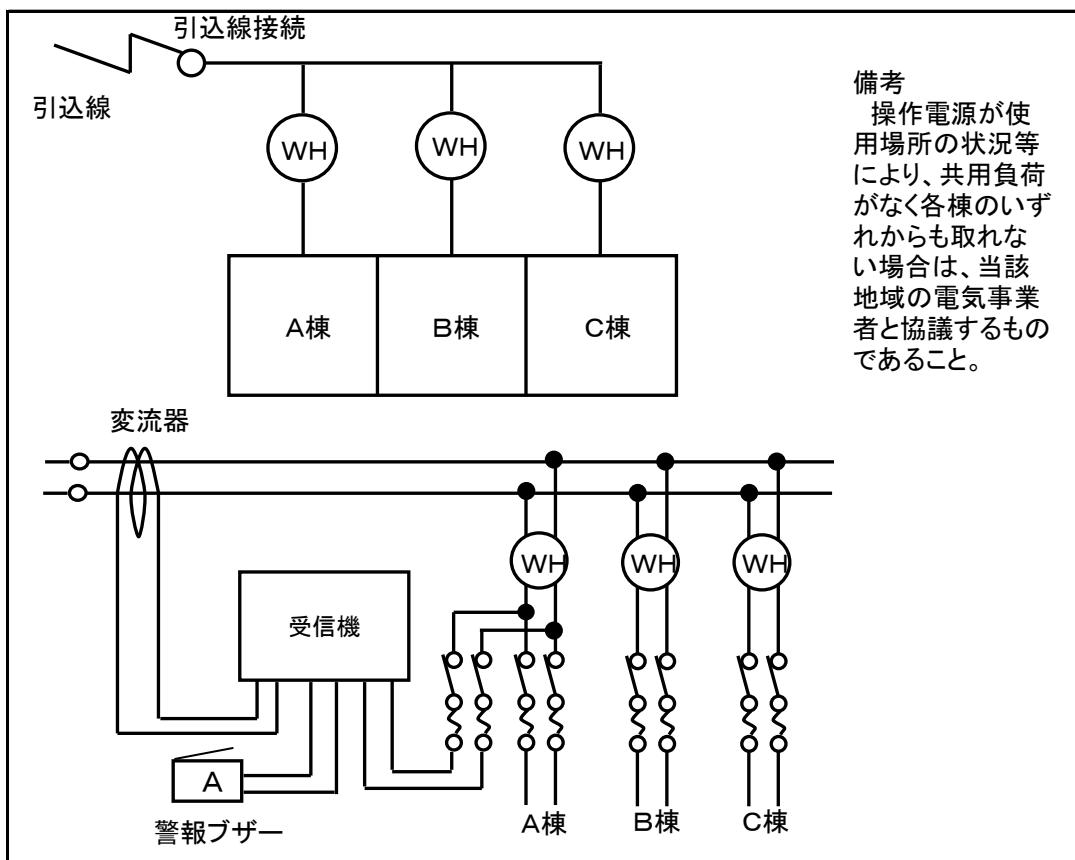
イ 各防火対象物に設けられている電力量計に至るまでの引込線が電気事業者の所有にかかる場合の例
